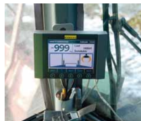
GROTENS VIKT registreras i skotarfordonets dator och skickas direkt och trådlöst till Skogsnäringens IT-företag SDC.
